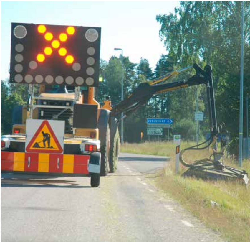
Figur 11. Den idag vanligaste typen av slåtteraggregat vid vägkantsskötsel har två roterande kedjor som slår av vegetationen och lämnar den som en söndertrasad massa i vägkanten.
