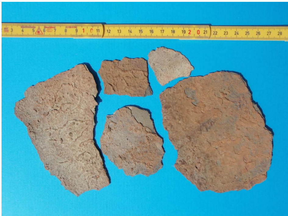
Bild 10. Metallsjok som slitits bort av vårfloden i rören under vägen.
