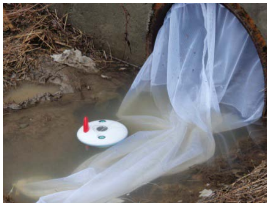
Bild 4. Temperaturen mättes digitalt, simultant i luft och vatten
